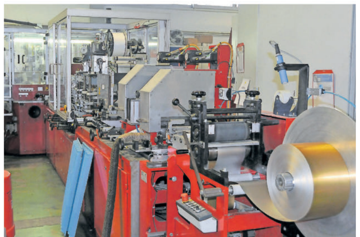
Schritt für Schritt werden die Maschinen bei Morlo in Rohrbach erneuert. Diese neue Anlage produziert in jeder Minute 200 Flaschenkapseln.
